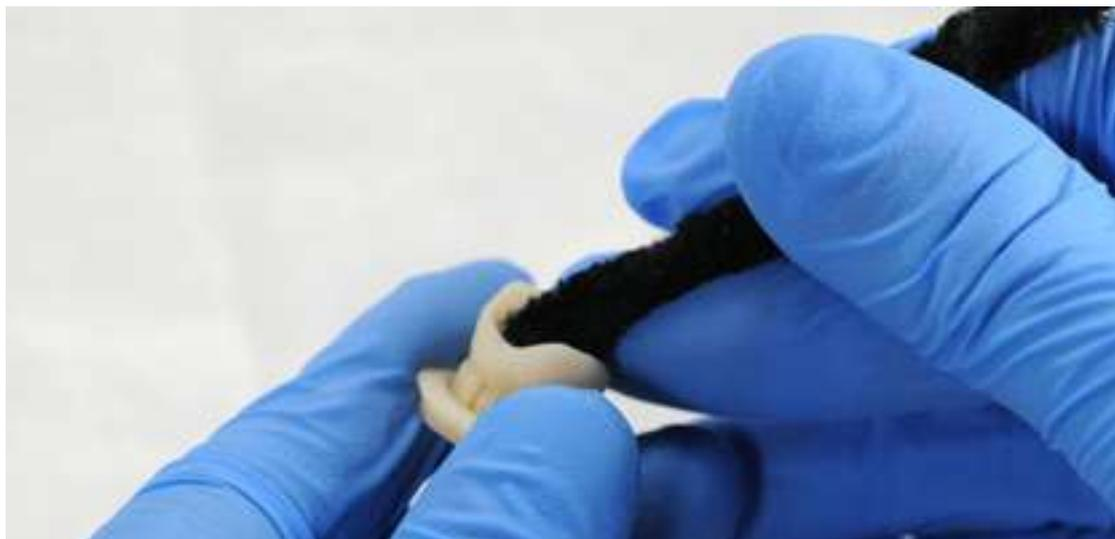
Utilisez une brosse ou un écouvillon pour retirer les excès de résine et réduire le temps de post-traitement ultérieur.
