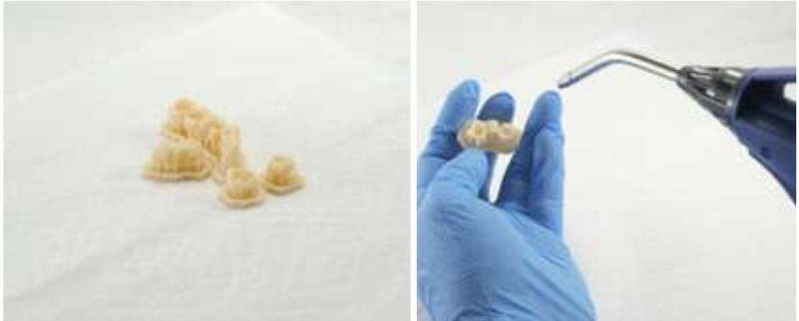
S'il reste la moindre trace de résine non polymérisée après le séchage, utilisez une bouteille à pipette contenant de l'alcool isopropylique propre pour l'enlever, puis recommencez le séchage.
